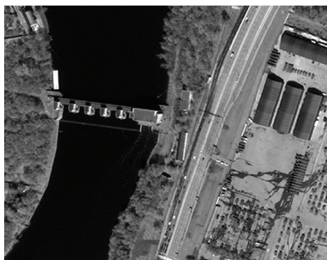
2. Плотина Карамышевской ГЭС (высота 18,5 м, длина 116 м), справа – бетонный завод
