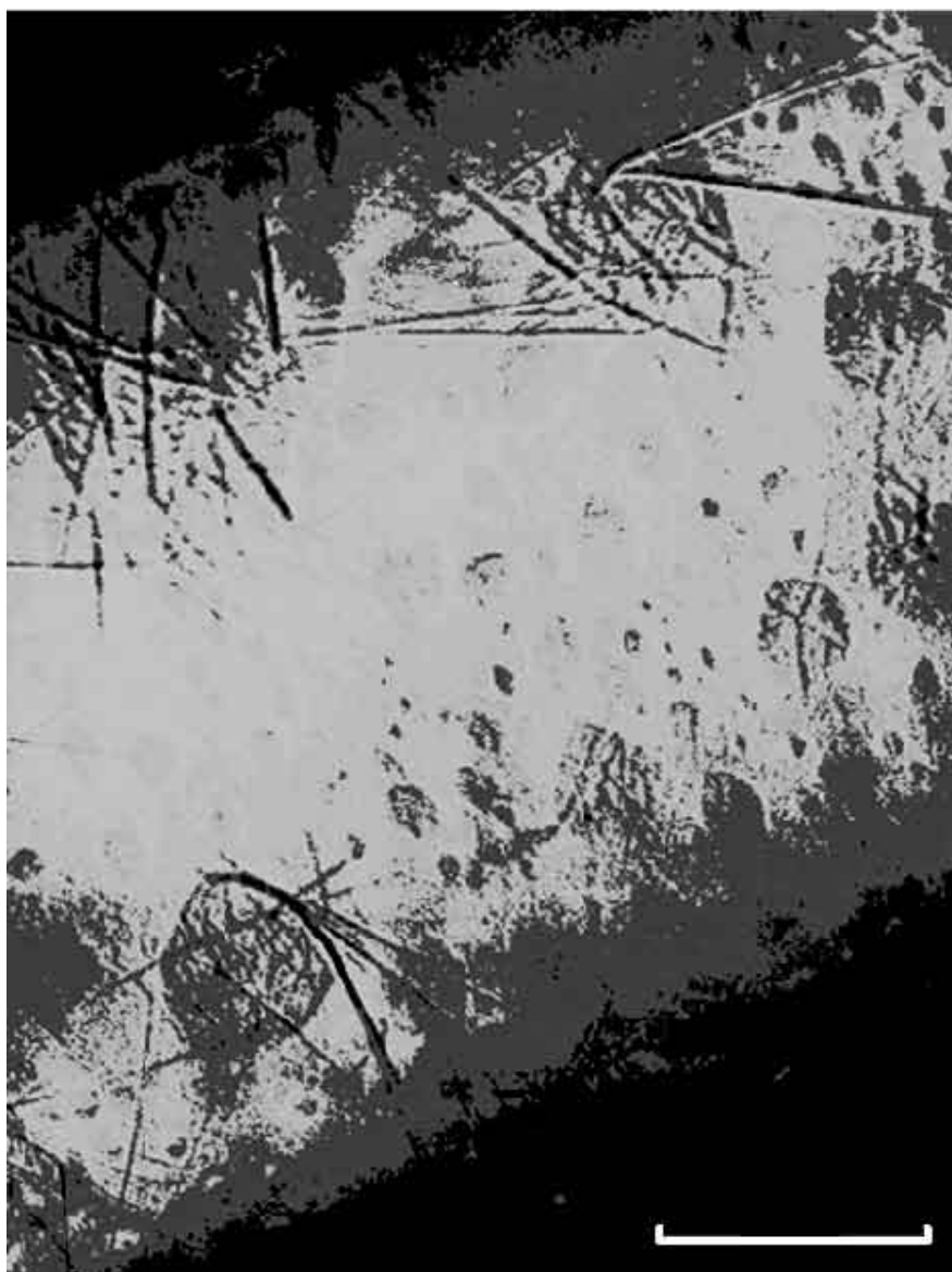
Рис. 6. Съемка на оптическом микроскопе МИКМЕД-6. Размер масштабного штриха 100 мкм. Интенсивный, хаотически направленный рост струн внутри и в окрестности капель. Коммутация капель посредством струн.
