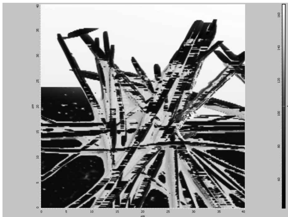
Рис. 6. АСМ, РФК. Горизонтальная и вертикальная шкалы – мкм, дополнительная – угловые градусы. Ксерогель раствора ТФААС-4 в гептане. 1 мг/мл. Точка (область) нульмерного инициирования крупным планом
