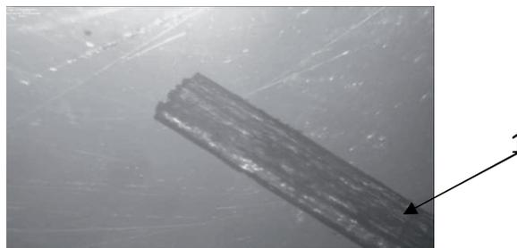
Рис. 1. Призматическая форма частицы карбамид (x300).
