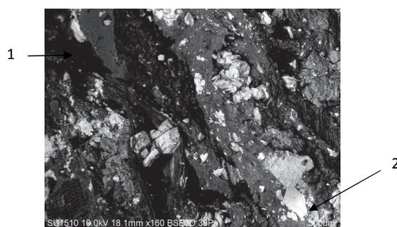
Рис. 5. Распределение минеральных компонентов в объеме гранулы: 1- торф; 2- минеральные компоненты (x160)
