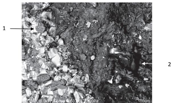
Рис. 4. Срез гранулы по поверхности раздела органической и минеральной составляющей: 1- минеральные компоненты; 2- торф (x550)
