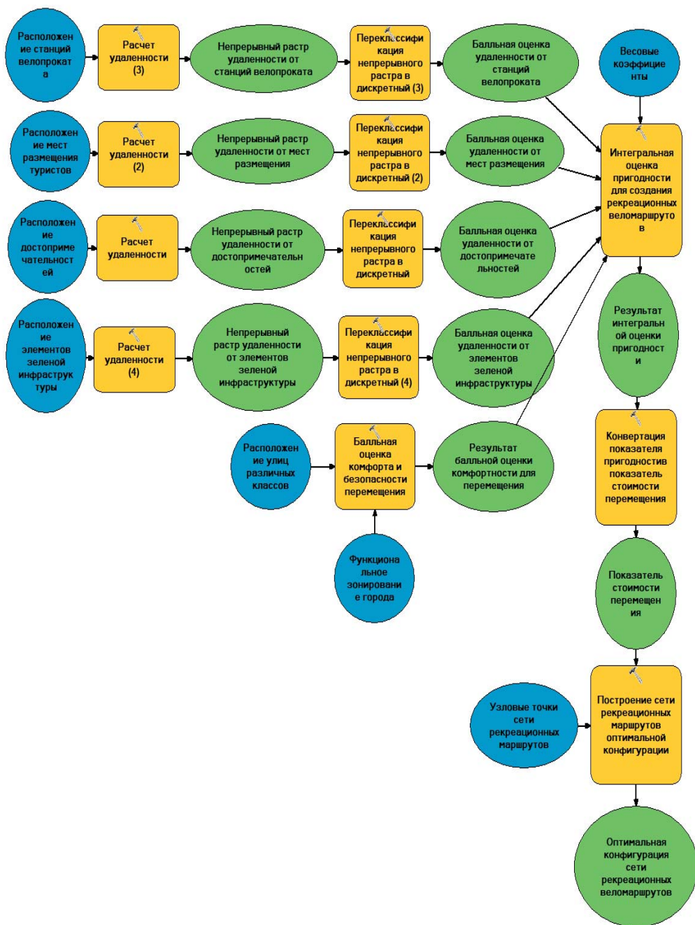
Рис. 1. Принципиальная схема алгоритма автоматизированного планирования сети рекреационных маршрутов в городах
