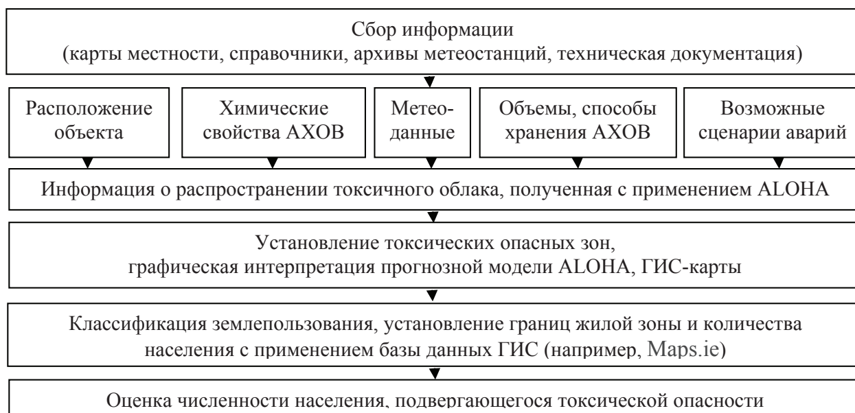
Рис. 3 / Fig. 3. Алгоритм оценки токсической опасности при аварии на химически опасном предприятии / The algorithm for assessing the toxic hazard in case of an accident at a chemically hazardous enterprise
