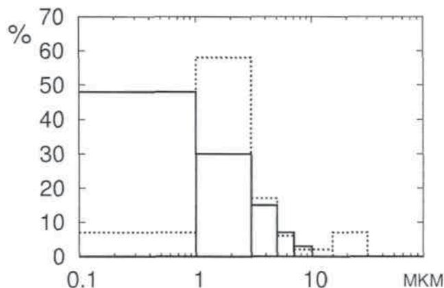
Рис. 1. Дифференциальное распределение частиц. Пунктирная линия – без рассекателя, сплошная линия – с рассекателем.
