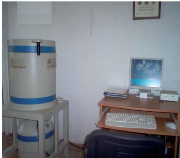
Рис.1. «CANBERRA»,  $\gamma$ -spectrometers with HP Ge detector.
