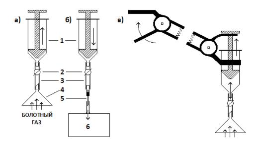
Рис. 1. Прибор для ручного забора проб болотного газа:1- шприц, 2- кран, 3- резиновая трубка, 4- воронка, 5- полая игла, 6- газовый хроматограф; а) и б)- устройство прибора и схема его работы; в)- схематическое изображение удлинителя, позволяющего брать образцы газа на расстоянии до 2 – 4-х метров.
