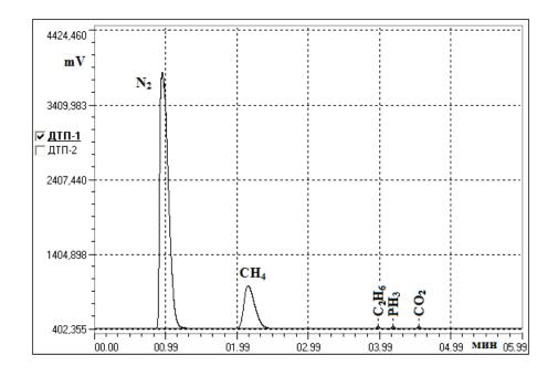
*Рис. 2.* Данные газо- хроматографического исследования болотного газа, полученные первым детектором (ДТП – 1).
