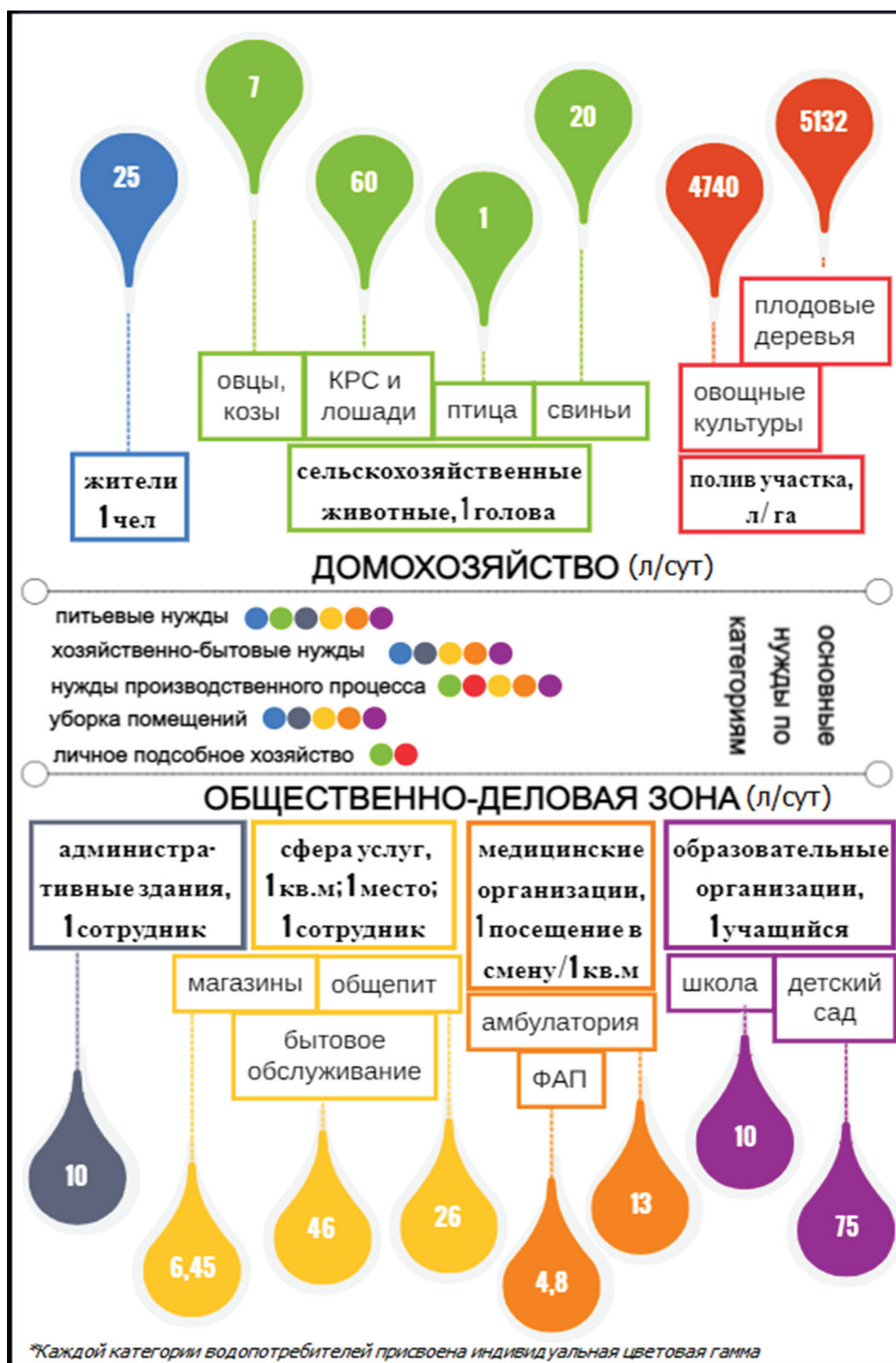
Рис. 5 / Fig. 5. Модель водопотребления среднестатистического сельского населённого пункта / Model of water consumption of an average rural settlement
