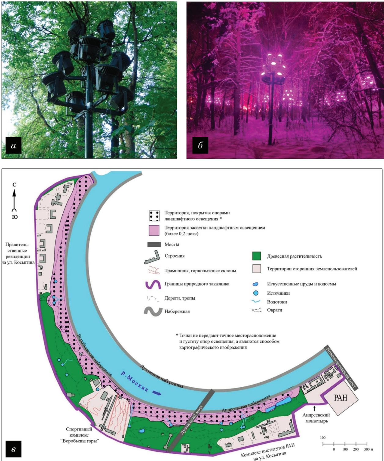
**Рис. 2 / Fig. 2.** Ландшафтное освещение на Воробьёвых горах: *a* – опора ландшафтного освещения с прожекторами; *b* – работающее ландшафтное освещение в зимнее время; *c* – пространственное распространение опор и засветки ландшафтного освещения / Landscape lighting in the Vorobyovy Gory Nature Reserve: *a* – landscape lighting pole with spotlights; *b* – landscape lighting in winter; *c* – spatial distribution of landscape lighting illumination and its poles.
