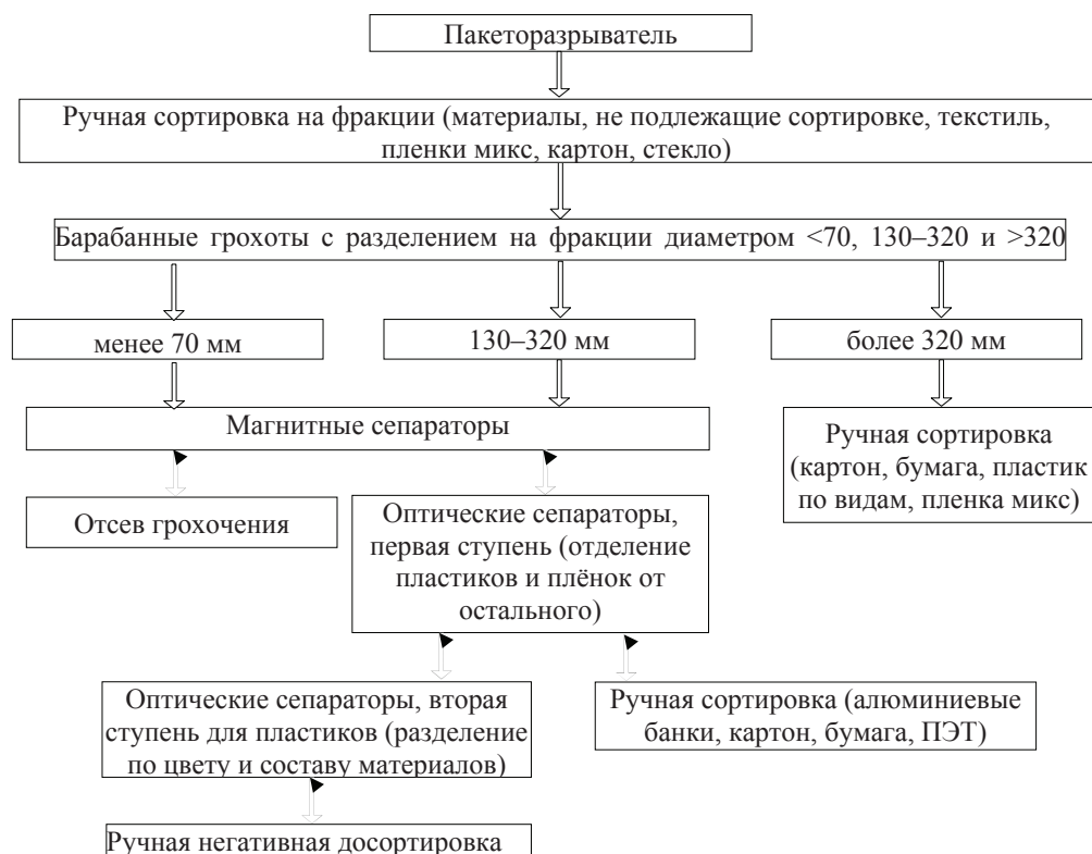
Рис. 2 / Fig. 2. Этапы сортировки на мусоросортирующих заводах / Sorting stages at a waste sorting plant
